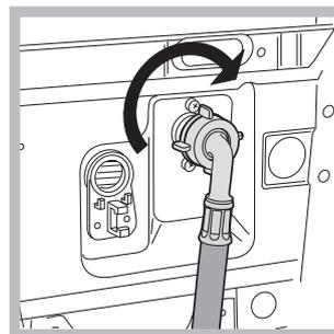
2. Raccordez le tuyau d'alimentation au lave-linge en le vissant à la prise d'eau prévue, dans la partie arrière en haut à droite (voir figure).
