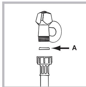
1. Inserire la guarnizione A nell'estremità del tubo di alimentazione e avvitarlo a un rubinetto d'acqua fredda con bocca filettata da 3/4 gas (vedi figura). Prima di allacciare, far scorrere l'acqua finché non sia limpida.
