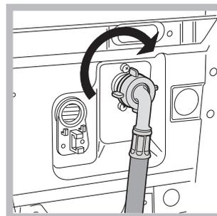
2. Collegare il tubo di alimentazione alla lavabiancheria avvitolandolo all'apposita presa d'acqua, nella parte posteriore in alto a destra (vedi figura).
