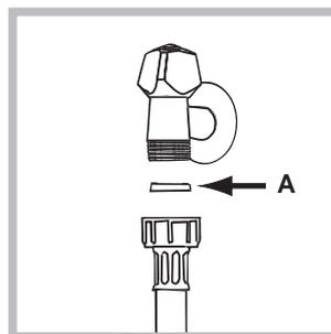
1. Montez le joint A sur l'extrémité du tuyau d'alimentation et vissez-le à un robinet d'eau froide à embout fileté 3/4 gaz (voir figure).
