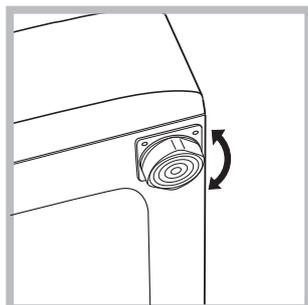
2. Jeśli podłoga nie jest dokładnie pozioma, należy wypoziomować pralkę, dokręcając lub odkręcając przednie nóżki (zobacz rysunek). Kąt nachylenia, zmierzony na górnym blacie pralki, nie powinien przekraczać 2°.
