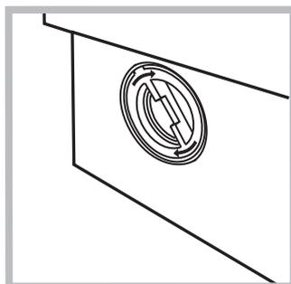
1. снимите нижний плинтус в передней части стиральной машины, потянув обеими руками за его края (смотрите рисунок);
